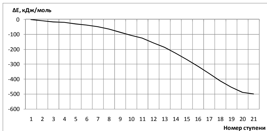
Рис. 7. Изменение общей энергии вдоль пути реакции присоединения протона H_1 к \beta -углеродному атому 1-метилтен-4-винилциклогексана
